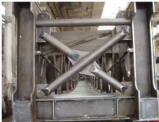
Obr. 5 Studie příčného řezu nad podporou
