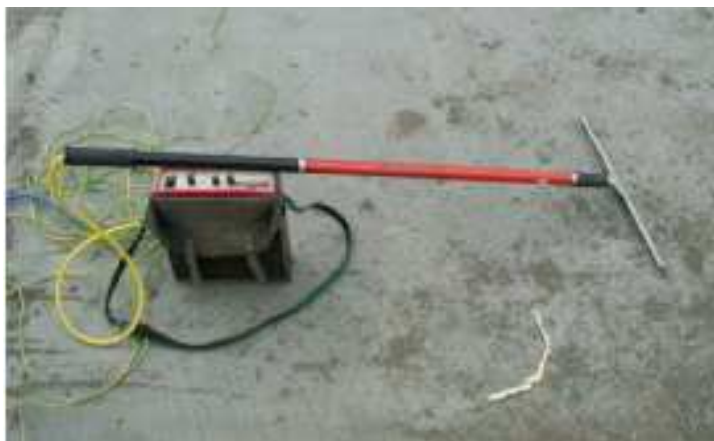
Obr 3: poroskop pro jiskrovou zkoušku
