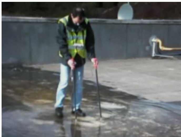
Obr 12: postup diagnostiky pulzní metodou
