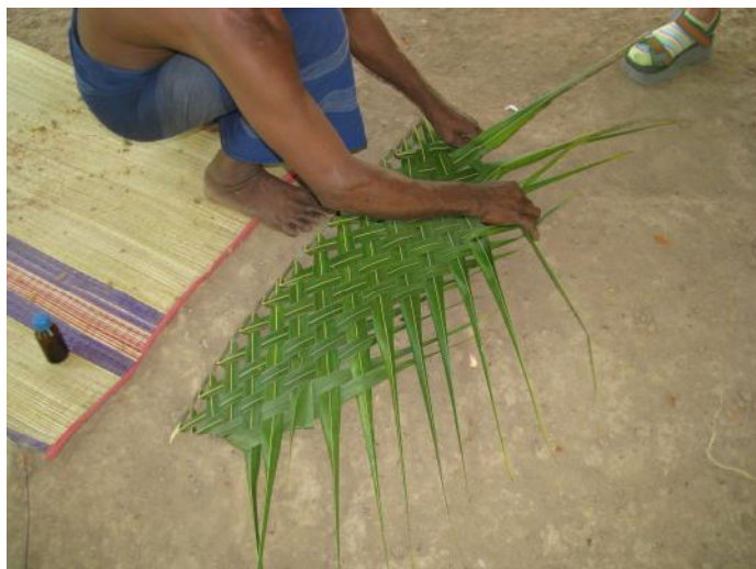
Obr. č. 3 – Výroba tvarovky pro střešní plášť
