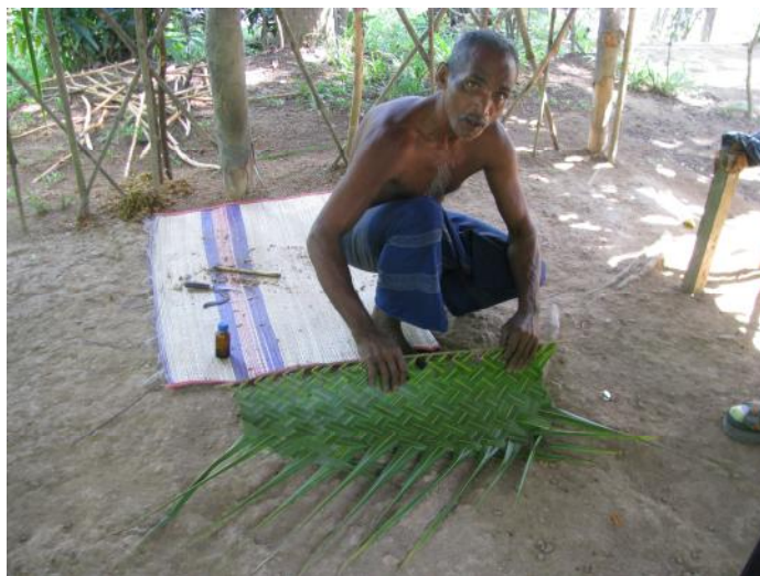
Obr. č. 2 – Výroba tvarovky pro střešní plášť
