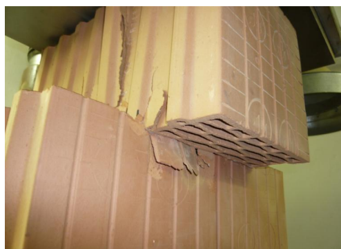
Foto č. 3 – Drcení dvou cihelných bloků PTH 30 CB a PTH 44 CB
