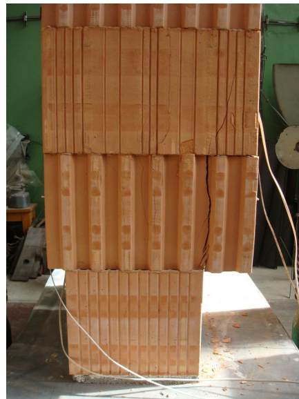
Foto č. 5 – Výsledek drcení stěnové soustavy PTH 30 CB a PTH 44 CB
