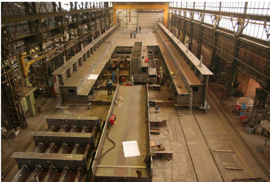
Obr. 3 Dílenská sestava mostovky a trámu
